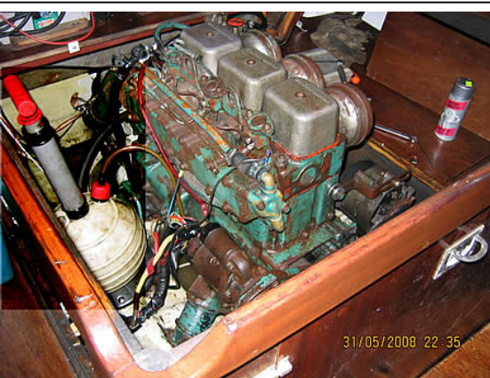
Variklio skyrius. Kairėje – tepalo siurblys, kuris puikiai tiko ne tik tepalui, bet ir triummo vandeniui pumpuoti.
